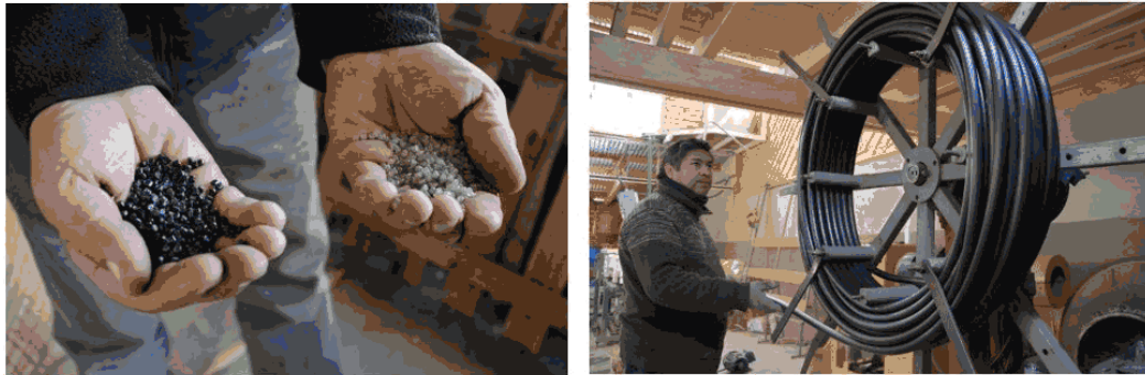
Imagen 2. Pellet de polietileno obtenido a partir del proceso de limpieza, triturado y fundición de bolsas de polietileno (Izq.). Manguera obtenida a partir de la fundición de los pellet de polietileno para distintos tipos de presiones (Der.).
